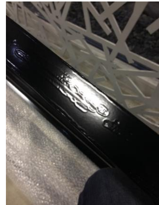
4. Oberflächenstörung durch Silikon
