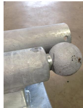
3. Weißrost auf verzinktem Geländerelement
